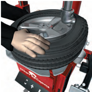
Рисунок 6 – Установка шины на обод
