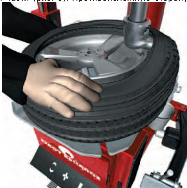
Рисунок 6 – Установка шины на обод
