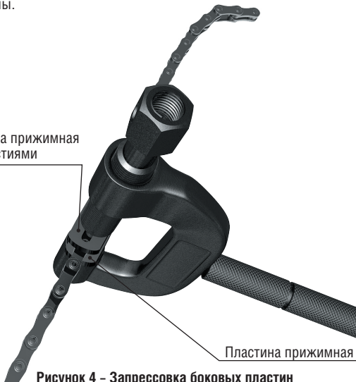
Рисунок 4 – Запрессовка боковых пластин
