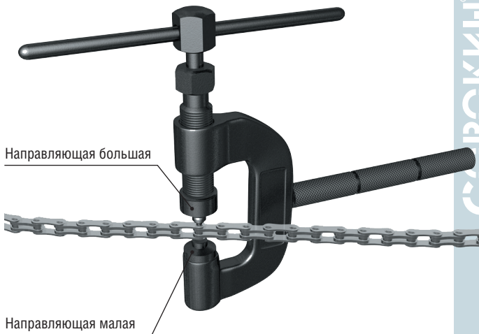
Рисунок 3 – Расклёпывание с применением наконечника 2,2 мм
