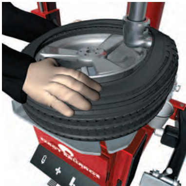
Рисунок 6 – Установка шины на обод
