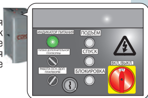
Рисунок 4 (а). Устройство пульта управления.
