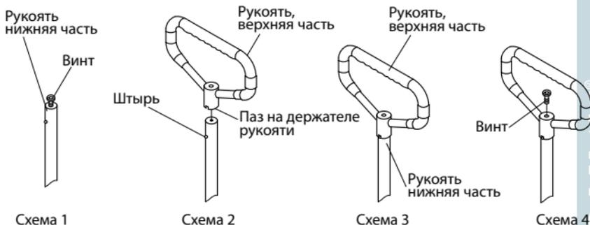
**Рисунок 9. Сборка верхней части рукояти.**
