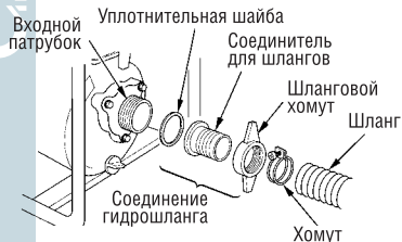
Рисунок 7. Подключение шлангов.
